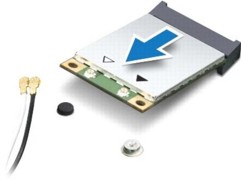
⚠ **تنبيه:** عندما لا تكون Mini-Card داخل الكمبيوتر، قم بتخزينها في غلاف واقى عازل للكهرباء الاستاتيكية. لمزيد من المعلومات، انظر "الحماية من تفريغ شحنة الكهرباء الاستاتيكية" في معلومات الأمان الواردة مع الكمبيوتر.
